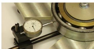
*Рис. 2.3. Устройство для измерения радиального зазора подшипников качения*
