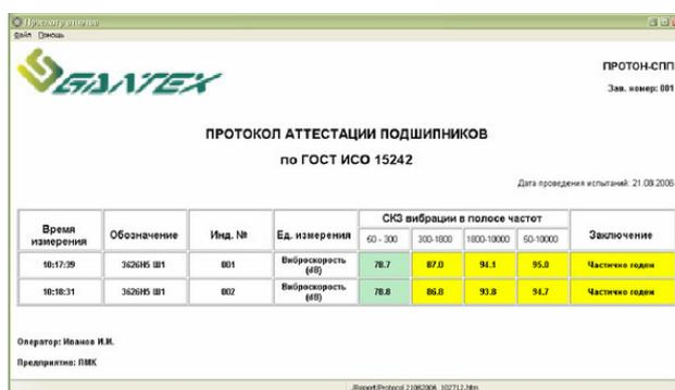
Рис. 2.7. Подготовленный для вывода на печать протокол аттестации подшипников качения по ИСО 15242—1—2004 [16]
