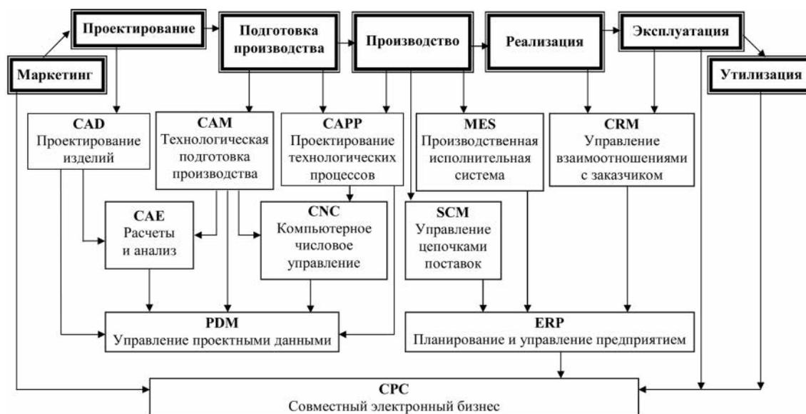
Рис. 1.3. Взаимодействие систем их автоматизации на этапах ЖЦ промышленных изделий
