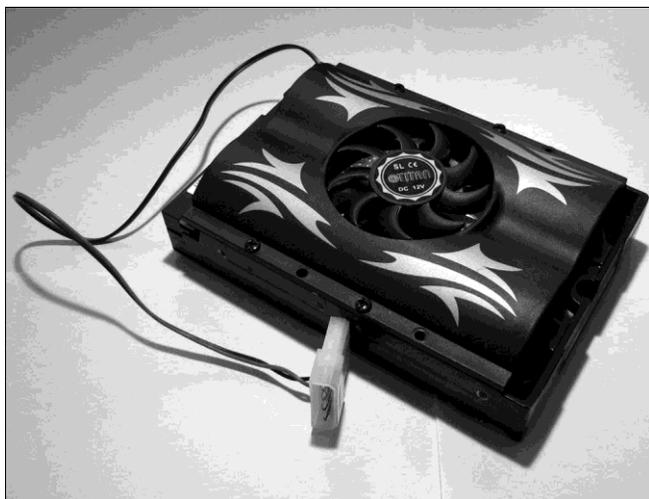
Рис. 1.2. Вентилятор с креплением на винчестере
