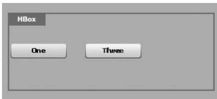
Рис. 11.3. Три кнопки внутри контейнера HBox ; для второй кнопки установлены свойства includeInLayout="false" , visible="true" (но третья кнопка ее перекрывает)
