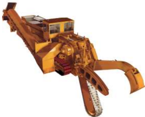
Рис. 1.1. Цифровой прототип многофункционального экскаватора, разработанного компанией Mastenbroek Ltd. (еще до изготовления проверка показала, что 17 тыс. деталей будут взаимодействовать безупречно)
