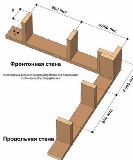
Рис. 9.14 Сборка каркаса по сетке 600 мм. Угловой стык фронтонной и продольной стены
