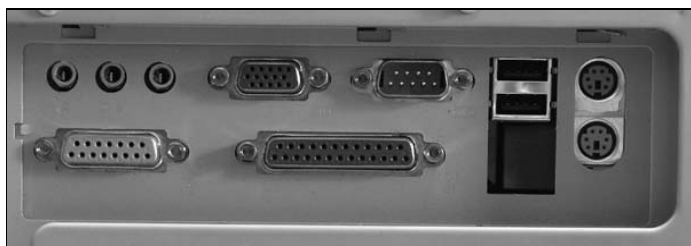
Рис. 1.7. Разъемы для подключения внешних устройств
