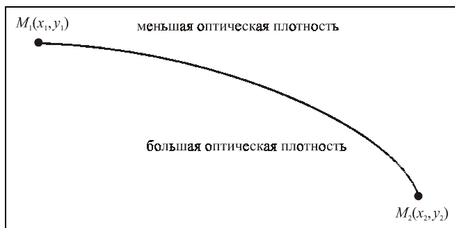
Рис. 1.8. Распространение света (принцип Ферма)
