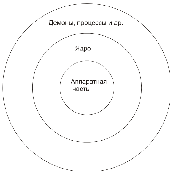
Рис. 1.1. Взаимодействие аппаратной части, ядра и процессов в Linux
