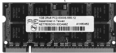
Модуль памяти для нетбука (SODIMM DDR)
