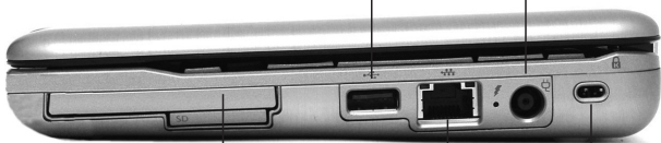
В кардридер вставляют карты памяти из телефонов, цифровых камер и т. д.
