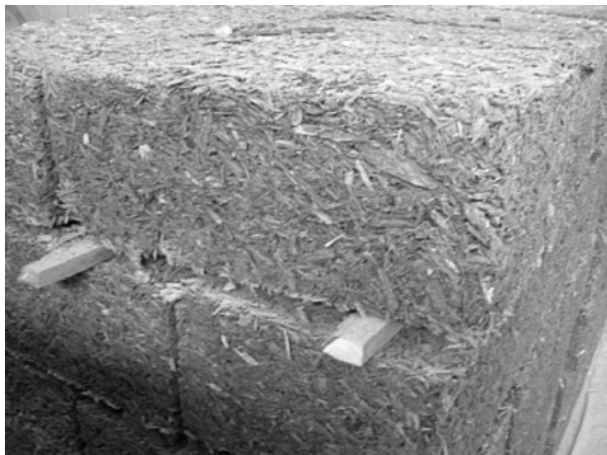
Рис. 1.5. Легкий бетон на древесном наполнителе
