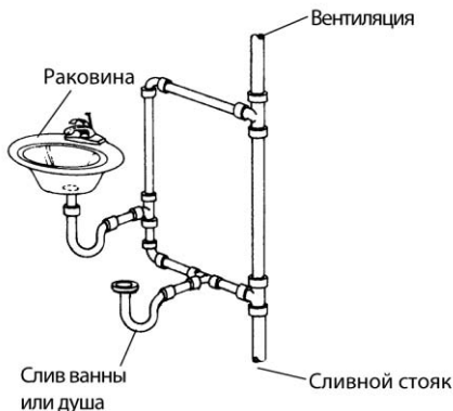
Рис. 1.9. Стандартные многотрубные соединения
