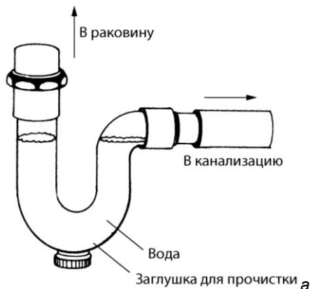
Рис. 1.11. Монтаж стандартного однооборотного сифона. В поперечном разрезе показано, как водосливная пробка препятствует проникновению газов из сточных труб (а). Установленный сифон без заглушки для его прочистки (б)
