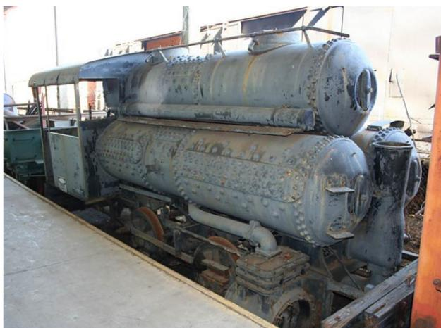
**Пневмолокомотив Портера с тремя баллонами. Этот локомотив-гигант типа 0—2—0 был построен для компании New Orleans Sewerage & Water Board в 1915 г. Он сохранён, но его текущее местоположение неизвестно. Фото с сайта «The Self Site: Unusual Steam Locomotives».**
