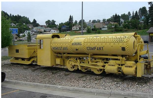
**Сохраненный локомотив Портера. 1928 г. Фото с сайта «The Self Site: Unusual Steam Locomotives».** Это сохранившийся образец более поздней разработки Портера. Был куплен в 1928 г. и оставался на службе до 1961 г. в шахте Хамстэйк №1А. Давление сжатого воздуха, запасаемого в резервуаре объёмом  $4 \text{ м}^3$ , составляло 70 атм. Масса 12,2 т, длина 7 м, ширина 1,6 м, высота 2,1 м. Выставлен для обозрения в шахте Хамстэйк в Южной Дакоте.
