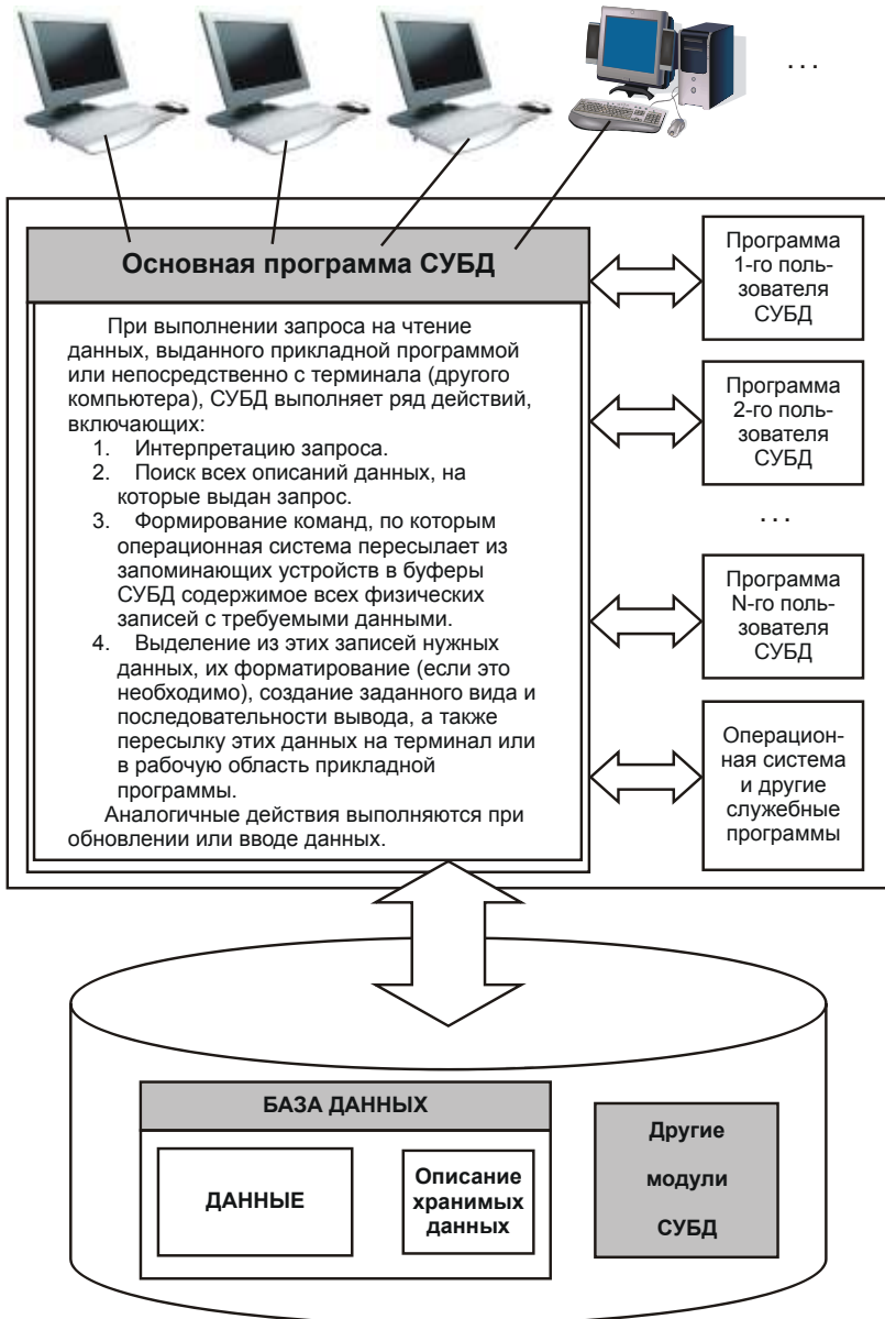
Рис. 1.2. Связь программ и данных при использовании СУБД
